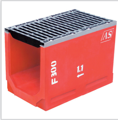
AS PPH, Korytka odpływowe z kratką AS-300. Wymiary: dł. 665 mm, szer. zewn. 393 mm, szer. wewn. 303 mm, wys. 585, 525, 465, 405, 345 mm. Rusztzy: żeliwne lakierowane lub z powłoką KTL w kl. C250 kN, D400 kN, E600 kN i F900 kN. Zakresy technologiczne: elementy bez spadku wewn., połączenia kaskadowe, łączenie pod kątem, studzienki z łapaczami zanieczyszczeń, dekle (z króćcem, zasłepiające), korpusy z otworami w dnie lub w bocznych ściankach (odprowadzenie wody).
