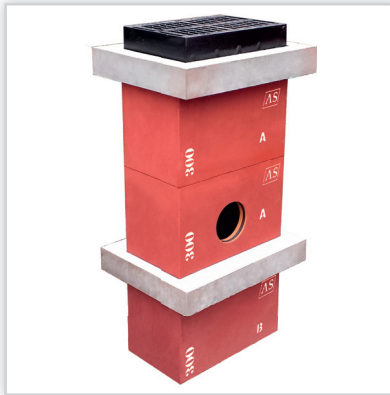
AS PPH, Studnie do wpustów ulicznych AS-ST300WU. Wymiary: szer. zewn. 393 mm, dł. 675 mm, szer. wewn. 303 mm, wys. element przelotowy 440 mm, element z dnem 450 mm. Możliwości technologiczne: studzienka w systemie AS może być jako rewizyjna, odpływowa lub osadnikowa i składa się z: pierścienia przejściowego pełnego lub 3/4 (pod wpust), pierścienia wzmacniającego, elementów pośrednich – "A", elementu z dnem "B", łapacza zanieczyszczeń.
