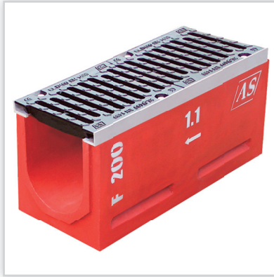
AS PPH, Korytka odpływowe z kratką AS-200. Wymiary: dł. 665 mm, szer. zewn. 292 mm, szer. wewn. 202 mm, wys. 383, 338, 295, 255 mm. Rusztzy żeliwne: lakierowane lub z powłoką KTL w kl. C250 kN, D400 kN, E600 kN i F900 kN. Zakresy technologiczne: elementy bez spadku wewn., połączenia kaskadowe, łączenie pod kątem, studzienki z łapaczami zanieczyszczeń, dekle (z króćcem, zasłepiające), korpusy z otworami w dnie lub w ściankach (odprowadzenie wody).
