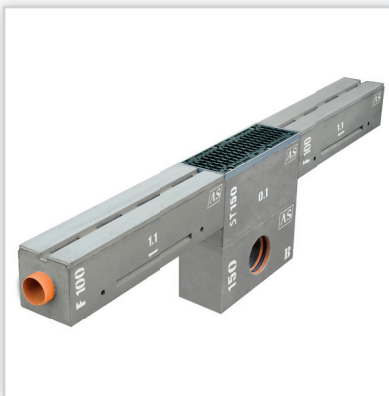
AS PPH, Odwodnienia szczelinowe monolityczne AS-S100. Wymiary: szer. zewn.: 242 mm, wys.: 245 mm, dł.: 1000 mm, średnica wewn.: \varnothing 110 mm. Zakresy technologiczne: elementy bez spadku wewn., możliwość łączenia elementów pod kątem, odprowadzenie wody oraz rewizje za pomocą studzienek wielofunkcyjnych AS-ST150.
