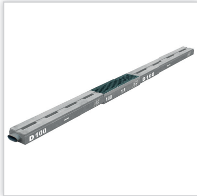
AS PPH, Odwodnienia szczelinowe monolityczne AS-A-S100. Wymiary: dł.: 1000 mm, szer. zewn.: 162 mm, szer. wewn.: 98 mm i 102 mm, wys.: 80 i 90 mm. Zakresy technologiczne: elementy bez spadku wewn., łączenia elementów pod kątem, odprowadzenie wody oraz czyszczenie za pomocą studzienek rewizyjnych, korki zamykające.
