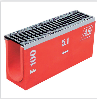
AS PPH, Korytka odpływowe z kratką AS-100. Wymiary: dł. 665 mm, szer. zewn. 162 mm, szer. wewn. 102 mm, wys. od 315 mm do 215 mm (spadek wewnętrzny 0,6%). Rusztzy: żeliwne z powłoką KTL w kl. B125 kN, C250 kN, D400 kN, E600 i F900 kN. Zakresy technologiczne: elementy ze spadkiem wewn. 0,6 % lub bez spadku, łączenie pod kątem, studzienki z łapaczami zanieczyszczeń, dekle (z króćcami, zasłepiające), korpusy z otworami w dnie lub w ściankach (odprowadzenie wody).
