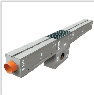
AS PPH, Odwodnienia szczelinowe monolityczne AS-S150. Wymiary: szer. zewn.: 292 mm, wys.: 305 mm, dł.: 1000 mm, średnica wewn.: \varnothing 160 mm. Zakresy technologiczne: elementy bez spadku wewn., możliwość łączenia elementów pod kątem, odprowadzenie wody oraz rewizje za pomocą studzienek wielofunkcyjnych AS-ST200.
