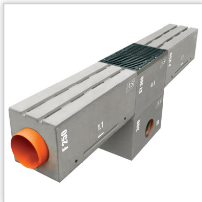
AS PPH, Odwodnienia szczelinowe monolityczne AS-IIS250. Wymiary: szer. zewn.: 393 mm, wys.: 420 mm, dł.: 1000 mm, średnica wewn.: \varnothing 250 mm. Zakresy technologiczne: elementy bez spadku wewn., możliwość łączenia elementów pod kątem, odprowadzenie wody oraz rewizje za pomocą studzienek wielofunkcyjnych AS-ST300.
