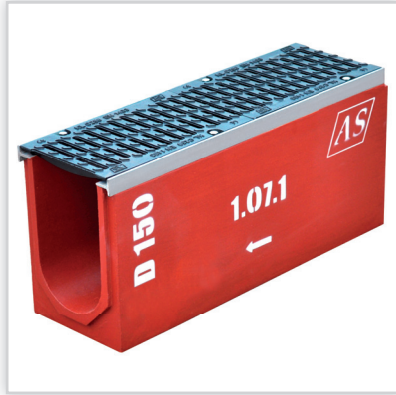
AS PPH, Korytka odpływowe z kratką AS-150T. Wymiary: dł. 665 mm, szer. zewn. 212 mm, szer. wewn. 152 mm, wys. 305, 265, 225, 185 mm. Rusztzy: żeliwne lakierowane lub z powłoką KTL w kl. C250 kN i D400 kN. Zakresy technologiczne: elementy bez spadku wewn., połączenia kaskadowe, łączenie pod kątem, studzienki z łapaczami zanieczyszczeń, dekle (z króćcami i zasłepiające), korpusy z otworami w dnie lub w ściankach (odprowadzenie wody).
